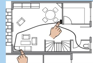
**Tip:** Schneiden Sie einen Faden, Draht o. ä. maßstäblich in Schlauchlänge ab und simulieren Sie auf Ihrem Plan den Saugschlauch. Wichtig: Kalkulieren Sie spätere Hindernisse wie Möblierung, Öfen, zusätzliche Wände usw. ein. Sie sollten Ihre komplette Wohnung oder Haus bequem mit dem Saugschlauch erreichen können, auch die oberste Ecke an der Decke, natürlich auch das komplette Treppenhaus.
