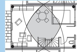
Schlagen Sie auf dem Grundriss jeder Etage von jeder Außenecke mit dem Zirkel (Faden und Bleistift tun's zur Not auch) einen Kreis mit einem maßstäblichen Radius von 8 oder 9 cm in der optimalen Schlauchlänge. In dem Bereich, in dem sich alle Kreise überschneiden, kann die Saugdose platziert werden.
